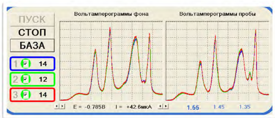
Рис.6. Вид вольтамперограмм слева – тест-система, справа – влияние жидкости передней камеры пациента на тест-систему.
